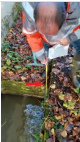
Laisse de crue à -74.5 cm du haut du rebord en ciment.
