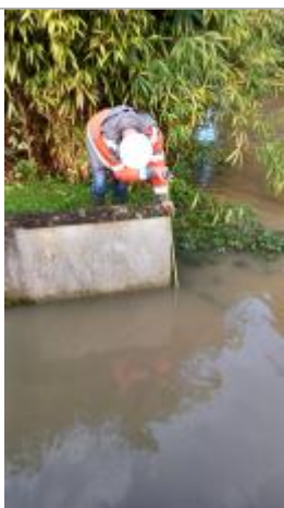
Laisse de crue à 74.5 cm du haut du muret.
