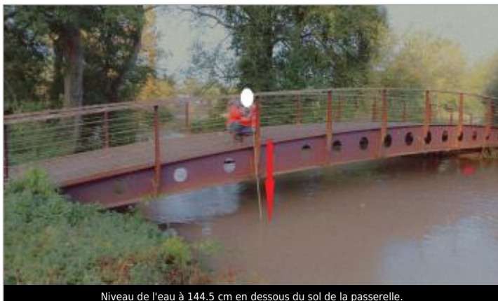
Niveau de l'eau à 144.5 cm en dessous du sol de la passerelle.
