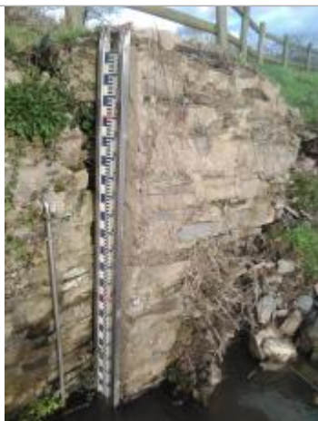
Ancienne échelle limnimétrique de la station Vigicruces d'Avessac (Painfaut)
