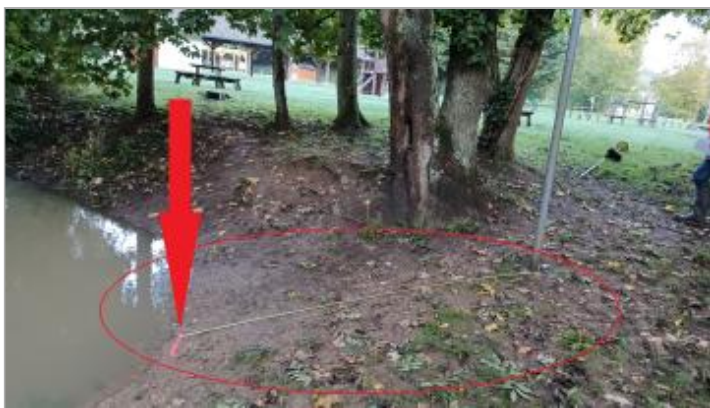
Laisse de crue au sol, à 266 Cm du panneau "Baignade interdite".
