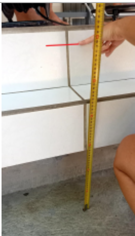
Témoignage de la hauteur d'eau
