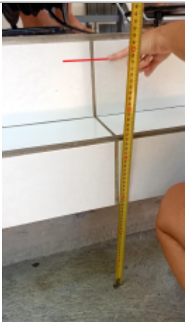
Témoignage de la hauteur d'eau
