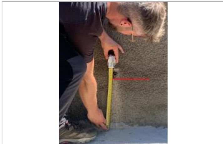
Témoignage de la hauteur d'eau
