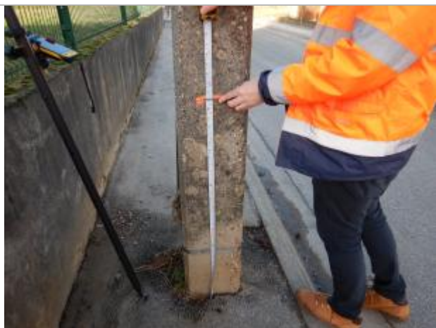
Le repère se trouve sur un poteau électrique
