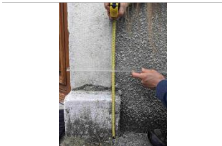
mesure prise à partir de la photo de la laisse/ pic de crue vers 4h30 du matin / photo prise lors de la décrue à 14h00
