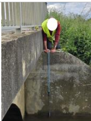
Laisse de crue à 54 cm du haut de la pile du pont (soit - 54 cm)
