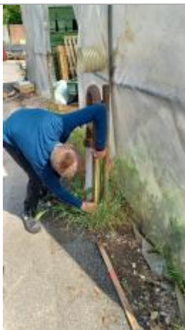
Laisse de crue à 52 cm/sol
