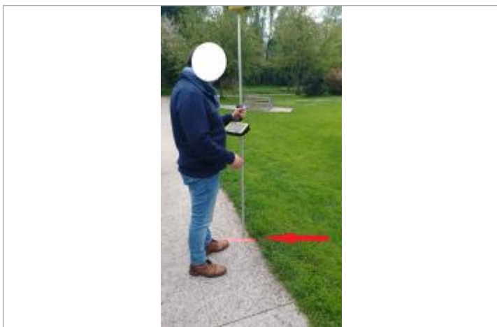
Laisse de crue au sol
