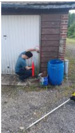
Laisse de crue à 550 cm/sol
