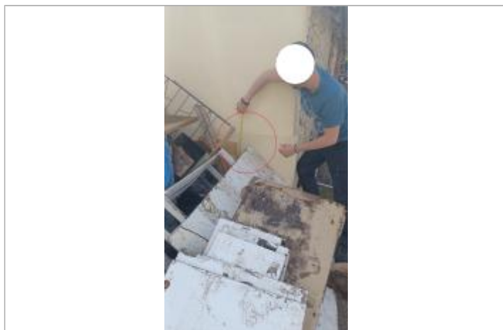
Laisse de crue à 80 cm/sol
