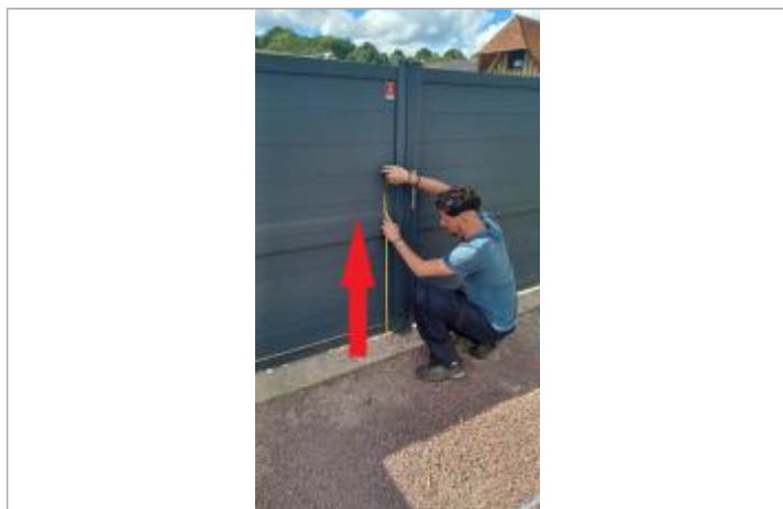
Laisse de crue à 88.5 cm/sol
