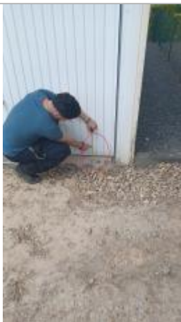
Laisse de crue à 13 cm/margelle sous la porte.
