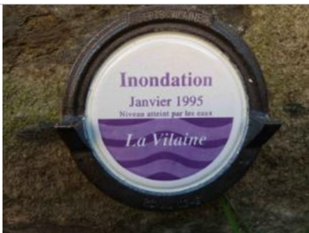
Repère normalisé de la crue de janvier 1995
