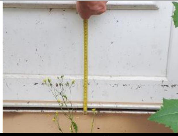
**SEUIL DE PORTE - 28/08/2024****Méthode :** GPS**Référence nivélée :** Marque d'inondation**Système altimétrique :** NGF IGN 1969 (système normal)**Altitude de la référence (en m) :** 356.918 m**Différence entre le niveau d'eau et la référence (en m) :** 0.110 m**Altitude calculée de l'eau (en m) :** 357.028
