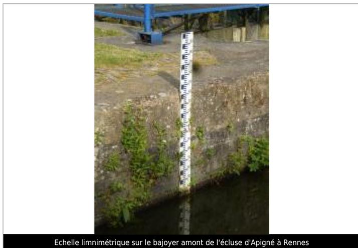
Echelle limnimétrique sur le bajoyer amont de l'écluse d'Apigné à Rennes
