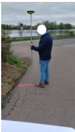
laisse de crue au sol.
