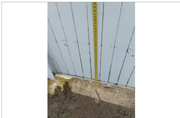
Laisse sur portail à 39cm du sol
