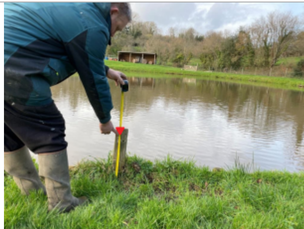
Localisation du piquet avec niveau d'eau connu
