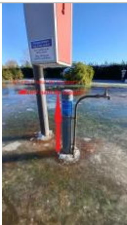
Laisse de crue à 13 cm/sol ou 65 cm/ haut du support du robinet
