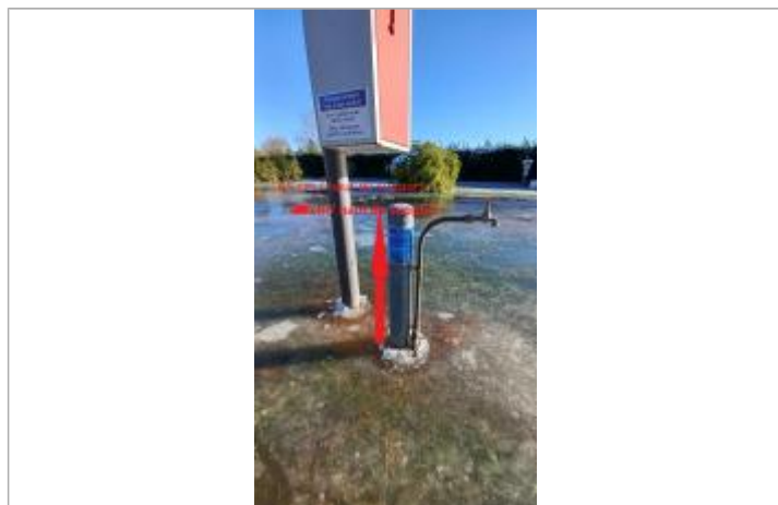
Laisse de crue à 13 cm/sol ou 65 cm/ haut du support du robinet
