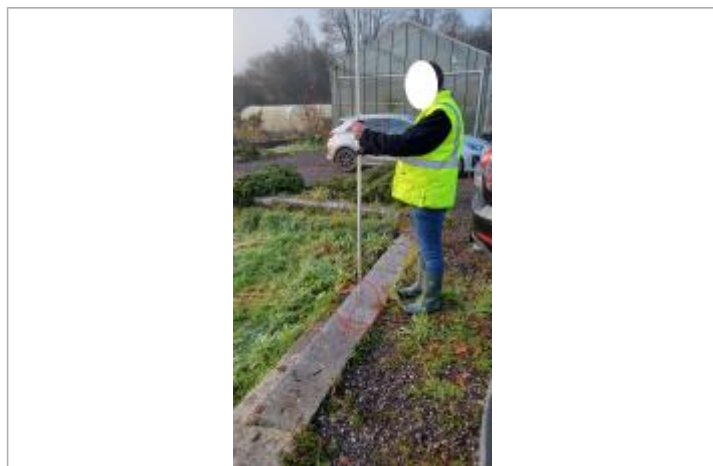
Laisse de crue à 5 cm au dessus de la margelle.
