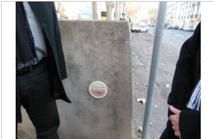
Repère posé sur un muret
