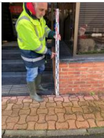
repère de crue mesuré au droit du muret (sur la base d'un témoignage)
