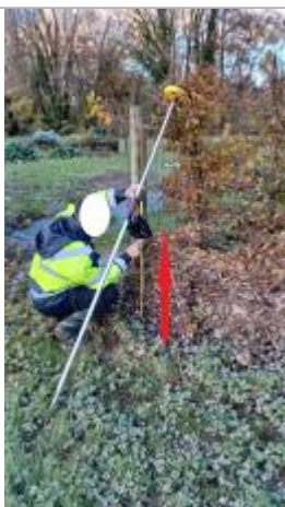
Laisse de crue à 80 cm/sol
