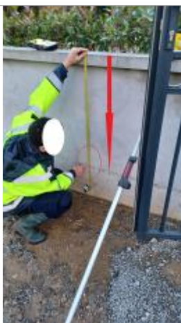
Laisse de crue à 89 cm/haut du muret.
