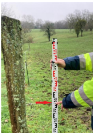
Premier fil de la clôture
