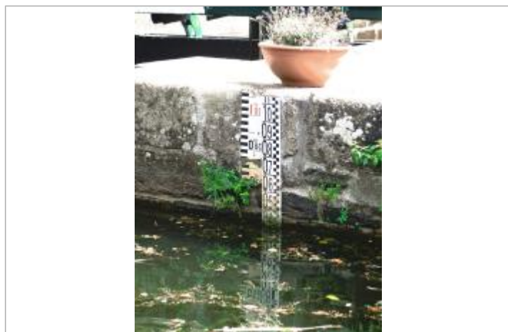
Echelle amont de l'écluse de La Née à Saint-Marcel
