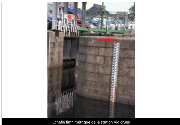
Echelle limnimétrique de la station Vigicrues
