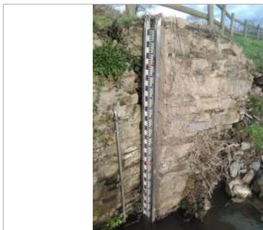
Ancienne échelle limnimétrique de la station Vigicrues d'Avessac (Painfaut)
