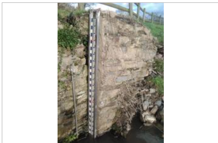
Ancienne échelle limnimétrique de la station Vigicrues d'Avessac (Painfaut)
