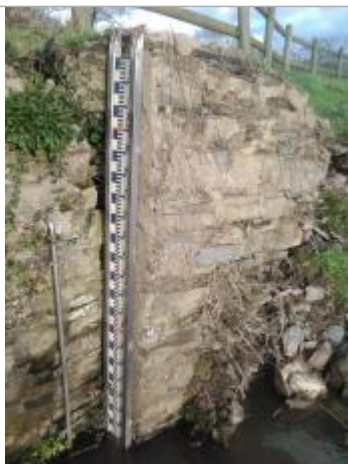
Ancienne échelle limnimétrique de la station Vigicrues d'Avessac (Painfaut)
