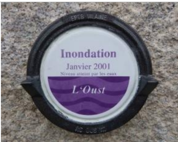
Repère normalisé de la crue de janvier 2001
