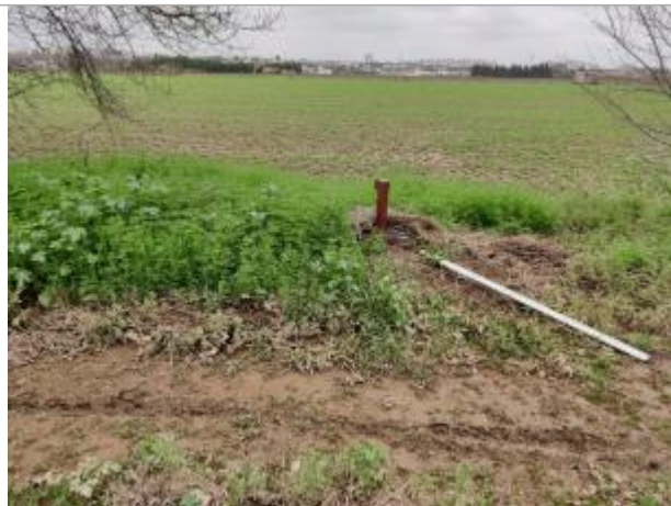
Plot béton du piézomètre
