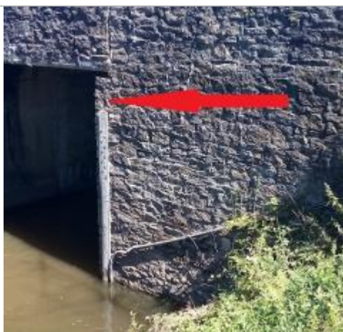
Echelle limnimétrique de la station Vigicrues de Cadoret-Pleugriffet
