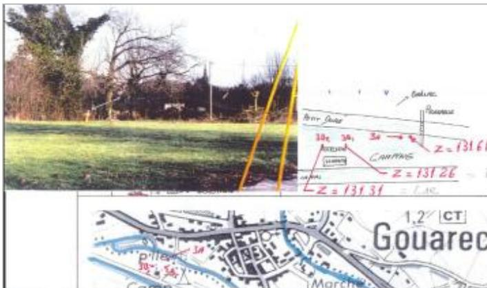
Photo et schéma de repérage des laisses de crues
