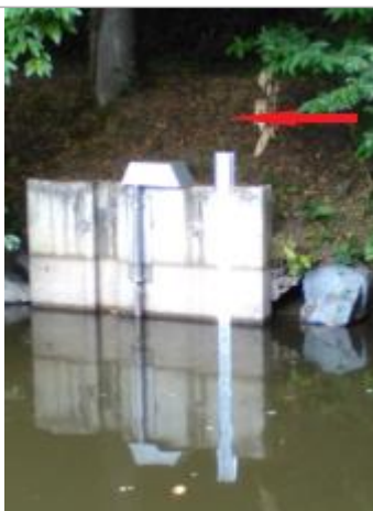
Echelle limnimétrique de la station de l'Arguenon entrée retenue
