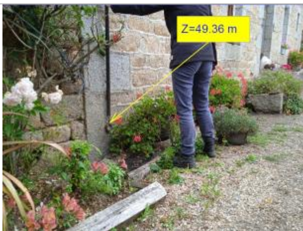
Repère lors du nivellement en 2022
