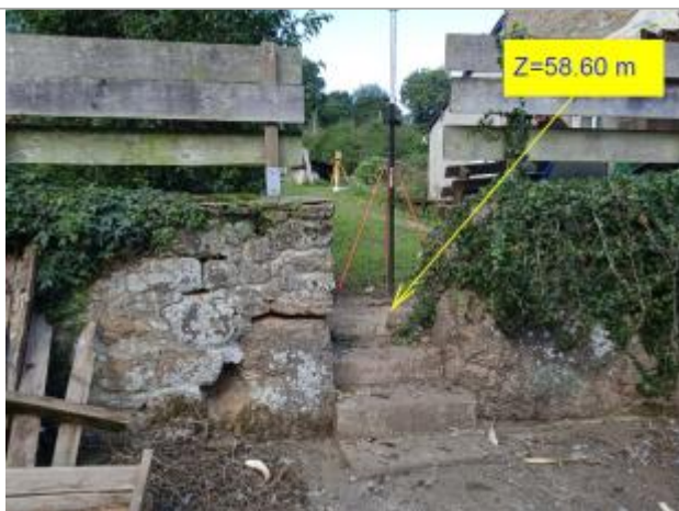
Marches donnant dans la cour et repérage nivellement
