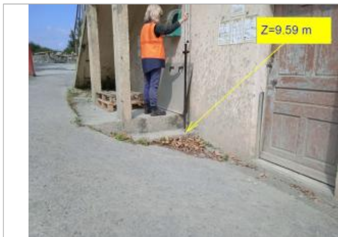
Repere lors du nivellement par la DDTM 22
